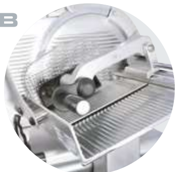
Piatto con braccio autobloccante Carriage with self-locking clamping device
